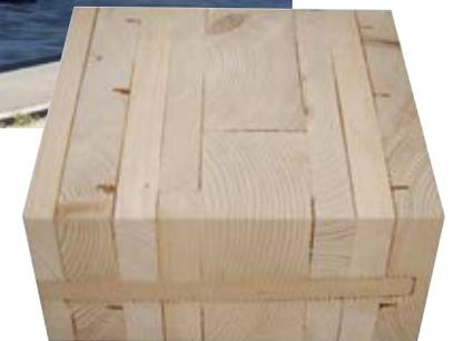
NUR-HOLZ – Die einstoffliche Massivholzbauweise aus dem Schwarzwald sorgt für unbelastetes Innenraumklima. Durch die von der Firma Rombach entwickelte und patentierte Verbindungsweise mit Buchenholzschrauben werden die einzelnen Lagen völlig leim- und metallfrei miteinander verbunden.
